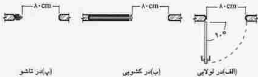
شکل شماره ۶۹: عرض مفید انواع در برای عبور صندلی چرخدار
