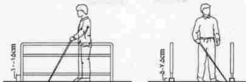
شکل شماره ۷۹. ارتفاع پایه میله دستگرد از کف
