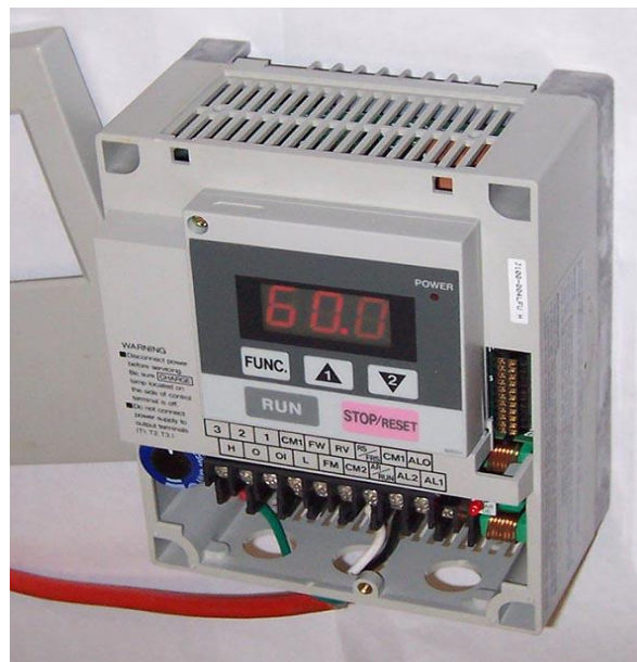
شکل ۱۰-۴ درایو فرکانس متغییر
